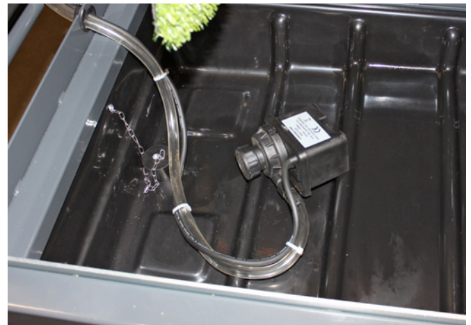
Überlaufstopfen im Abfluss der Wasserwanne, Wasserpumpe in der Wasserwanne
