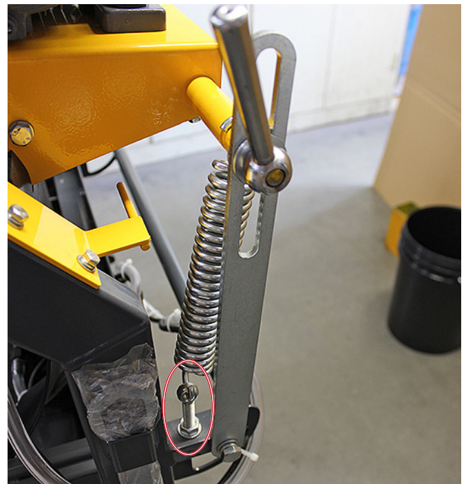
Spanschraub zum Spannen der Pendelschneidarmfeder
