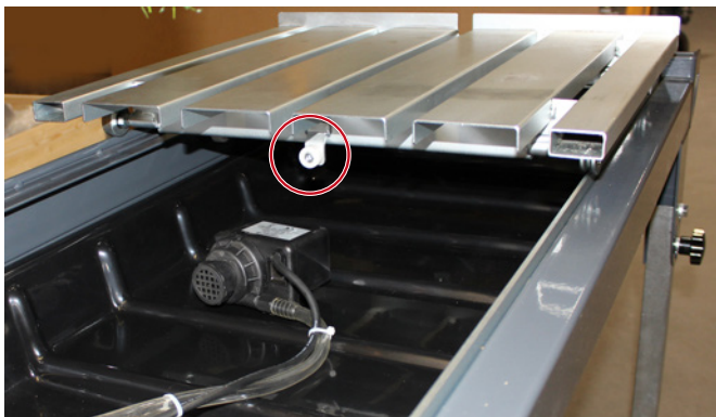
Rolltisch-Anstoßdämpfer hinten, Wasserpumpe in Wasserwanne
