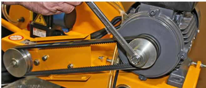
Befestigungsschraube an der Keilriemenscheibe lösen Bild 5.11
