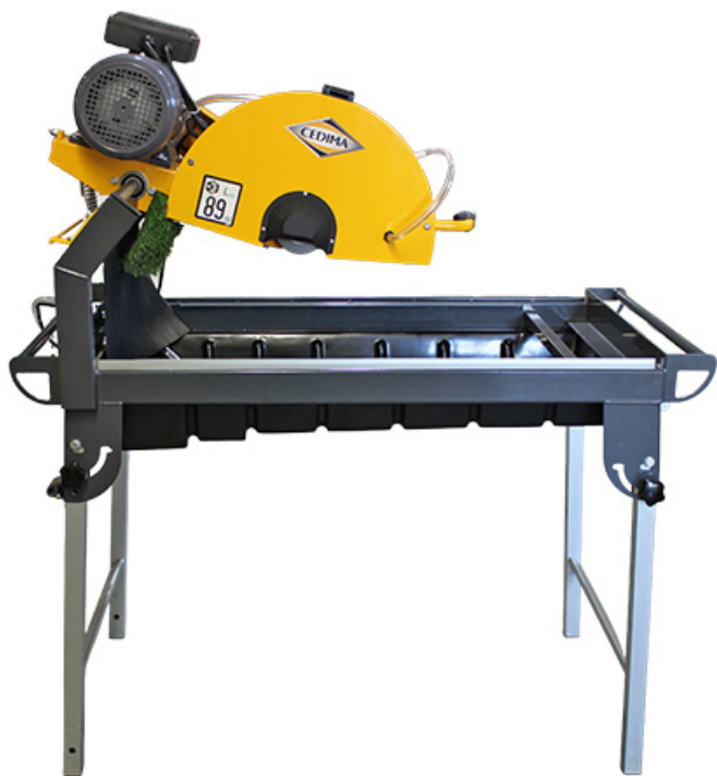
Standfußpaare abgeschwenkt, Tischsäge aufgestellt Bild 4.10
