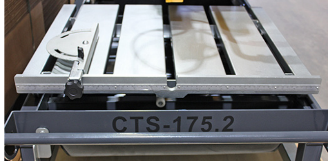
Winkelanschlag auf den Werkstückanschlag des Rolltisches geklemmt Bild 4.16
