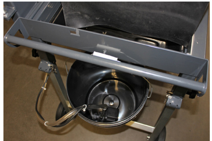
Wasserpumpe im Baueimer am Tischsägerahmen
