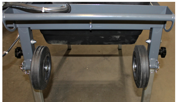
Rollen oben am Tischsägen-Rahmen montiert
